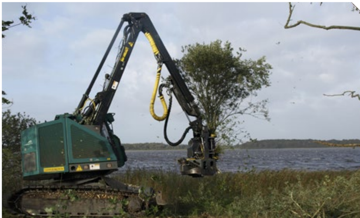
Rydning af træopvækst med specialudviklet materiel.
