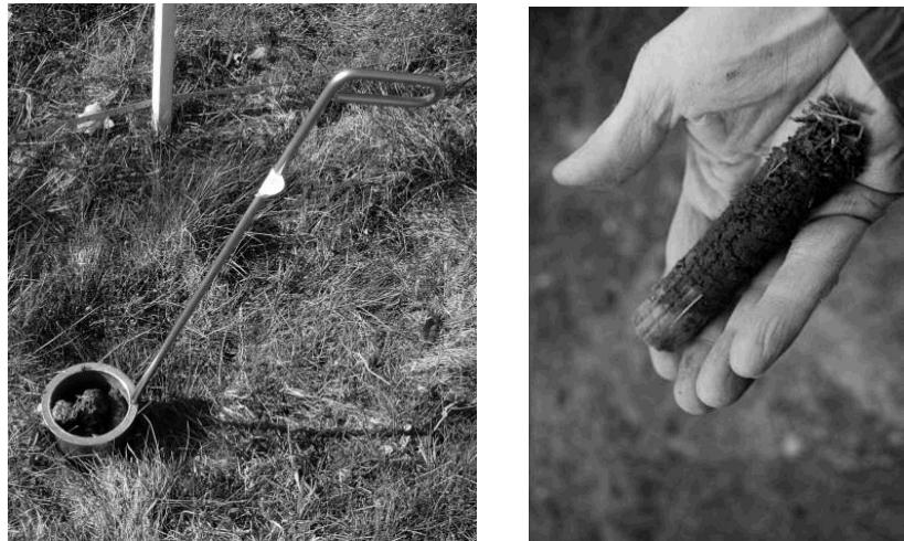
**Figur 2:** Foto af golfbaneprøvetager (tv.) til udtagning af cylinderformede increments (th.), increment-størrelse 10 cm, ø25 mm, svarende til ca. 80 gram jord.
