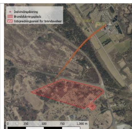
Figur 4.2: Partikelbaner fra de fire indvindingsscenarier S2
