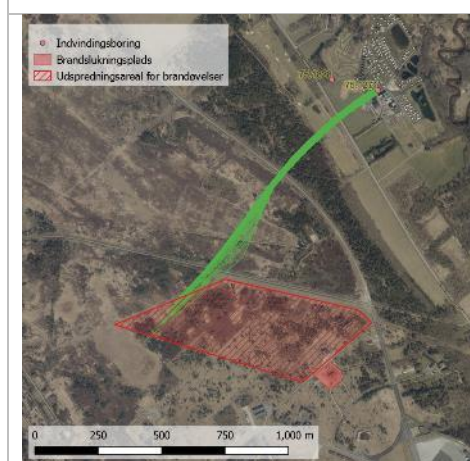
Figur 4.3: Partikelbaner fra de fire indvindingsscenarier S3
